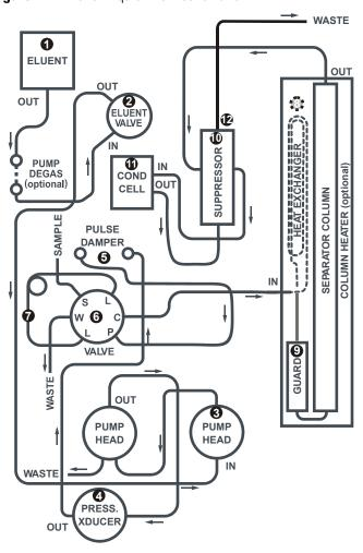
**Figure 7.** Dionex Aguion flow schematic
