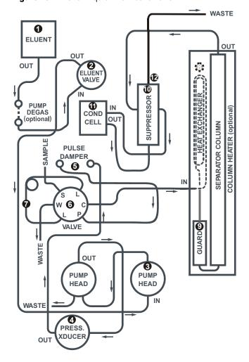
Figure 23. Dionex Aquion flow schematic
