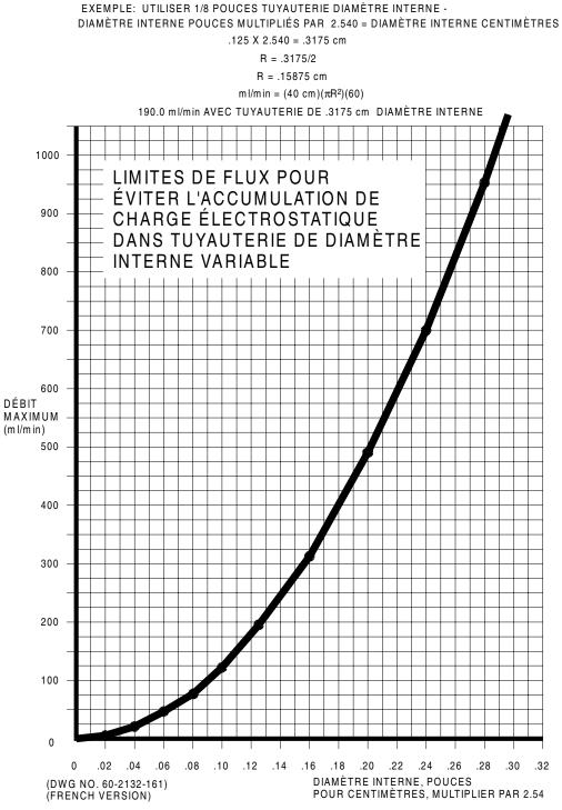
Limites du flux des liquides non-conducteurs pour éviter l'accumulation de charge électrostatique dans la tuyauterie du diamètre interne variable
