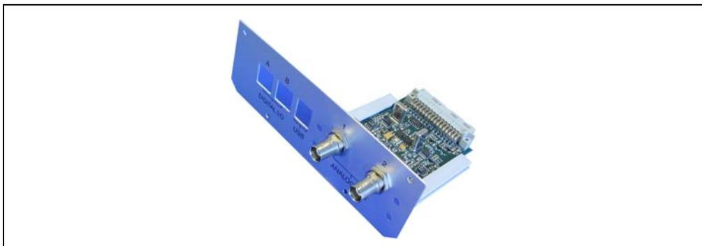
Figure B-8. DAC Plug-In Module
